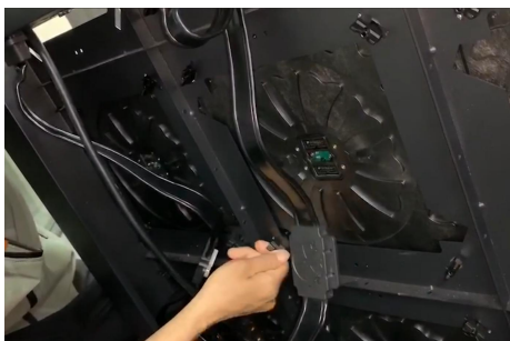
■ 将背面螺栓扭转至箱体栓口平齐
